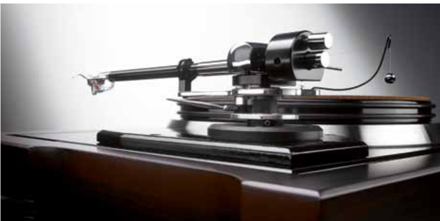
MASSGENAU: Das Armrohr wird in Aufbau und Masse von Origin Live auf die Nadelnachgiebigkeit des geplanten Systems – hier ein Lyra Atlas – feingetunt.
