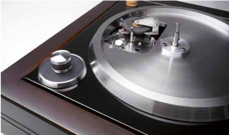
KRAFTVOLL: Das rubingelagerte Reibrad vermittelt zwischen der 5 mm starken Motorwelle und der Innenseite des (hier abgenommenen) Tellers. Das resultierende Drehmoment ist enorm.
